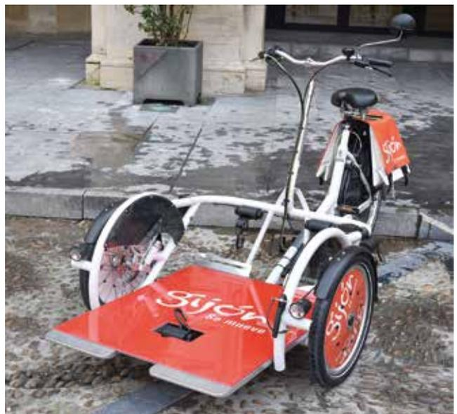
El **MODELO OPAIR** es una combinación entre una bicicleta y una silla de ruedas para llevar a una persona que por sus circunstancias no puede desplazarse, cuentan con reposacabezas, reposabrazos y cinturones. Además de contar con baterías que la convierten en una bicicleta eléctrica para facilitar superar desniveles.
