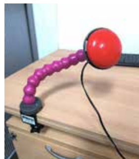
Brazo Flexible para colocación de dispositivos (pulsadores, móvil, Tablet).
